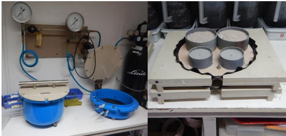
Fig. 4 – Equipos utilizados para determinar SWCC de forma experimental
